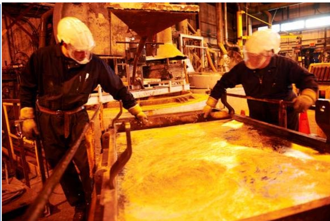
LA FONDERIE GÉNÉRALE DU CANADA TRANSFORME DU PLOMB EN LINGOTS ET AUTRES DIFFÉRENTS PRODUITS.
